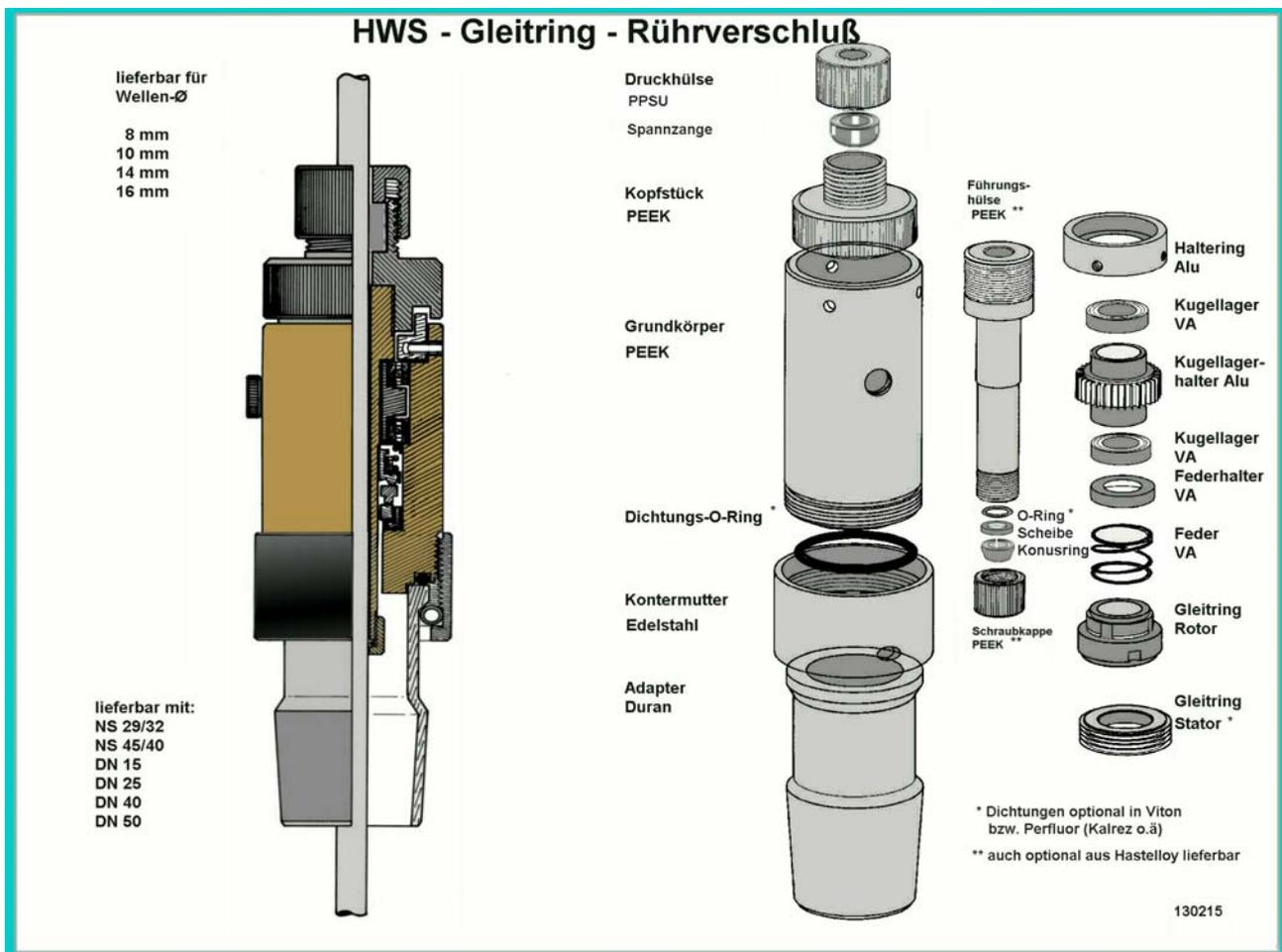
In Gleitring-Rührverschlässen der neueren Generation wird anstelle der Klemmringe aus Viton eine Spannzange aus Polypropylen (PP) eingesetzt. Mit dieser Spannzange können auch Rührwellen mit PTFE-Überzug problemlos eingesetzt werden.
